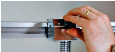
6 Befestigen Sie die Profile mit der Schraube.
