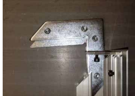
Zwei Eckverbinder übereinander in das Profil einschieben
